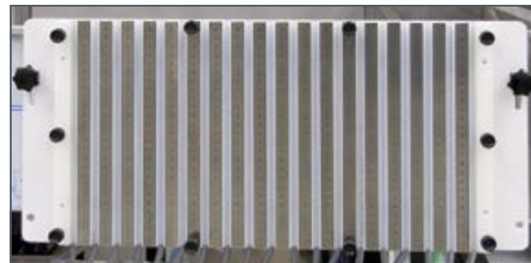
19 tubos manométricos permiten una medición muy detallada del nivel de agua subterránea.
