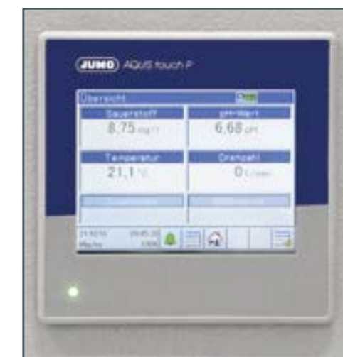
Regulador de proceso digital para indicación de las magnitudes del proceso y para regulación de la concentración de oxígeno
