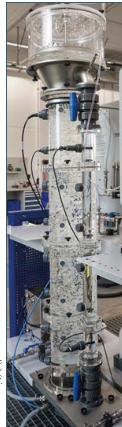
Reactor airlift durante una operación de prueba
