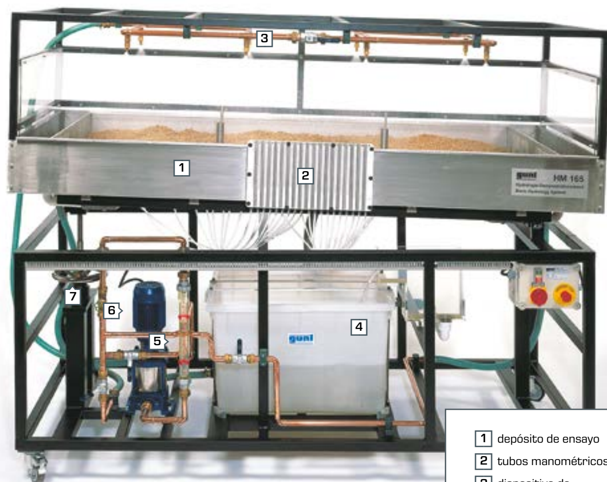
Dispositivo de precipitación con toberas para una simulación realista de las precipitaciones
