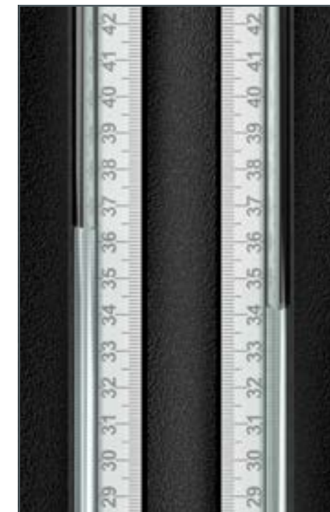
El manómetro de tubos permite determinar pérdidas de carga bajas con un alto grado de precisión.
