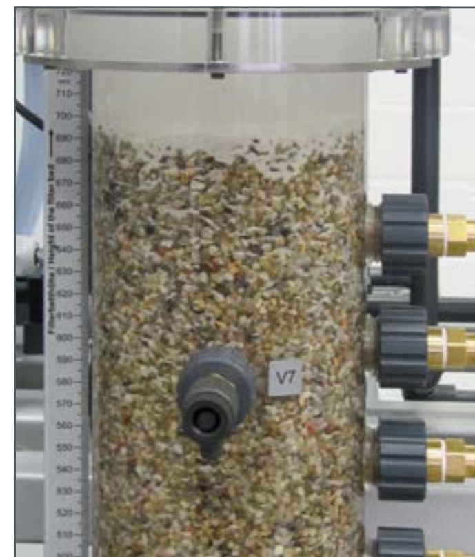
Tubo de filtro transparente para observar el aumento de la carga del lecho filtrante
