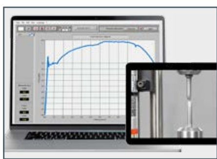
Adquisición de datos: se registran la fuerza y la longitud
