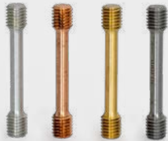
Probetas de tracción con sección circular según DIN 50125, material: Al, Cu, St, CuZn
