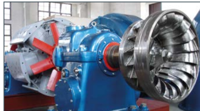
Turbina Francis desmontada
