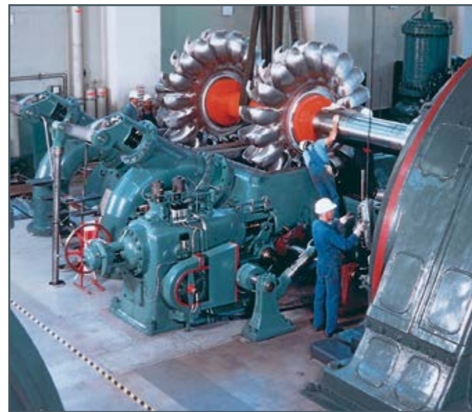
Montaje de una turbina Pelton en la central energética de Walchensee, Alemania (Voith Siemens Hydro Power)
