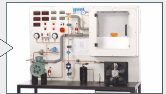
Instalación frigorífica con compresor abierto
