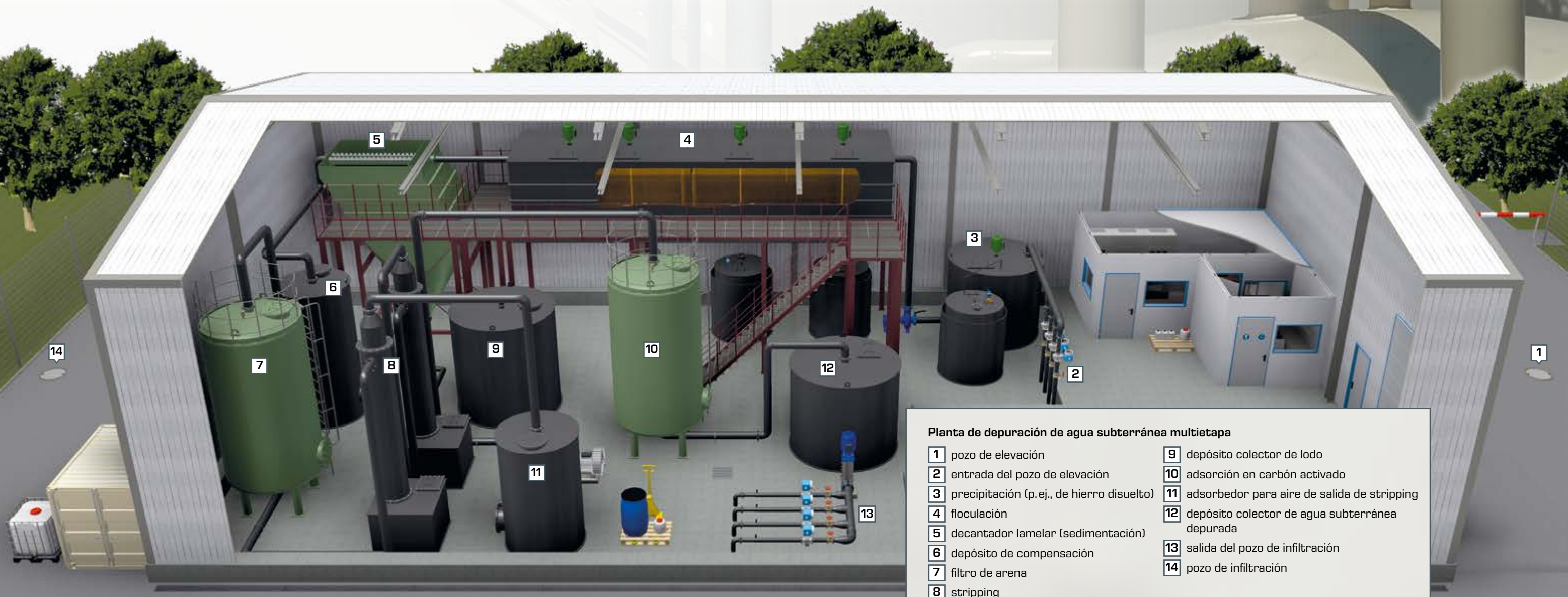
Pozo de elevación de agua subterránea contaminada
