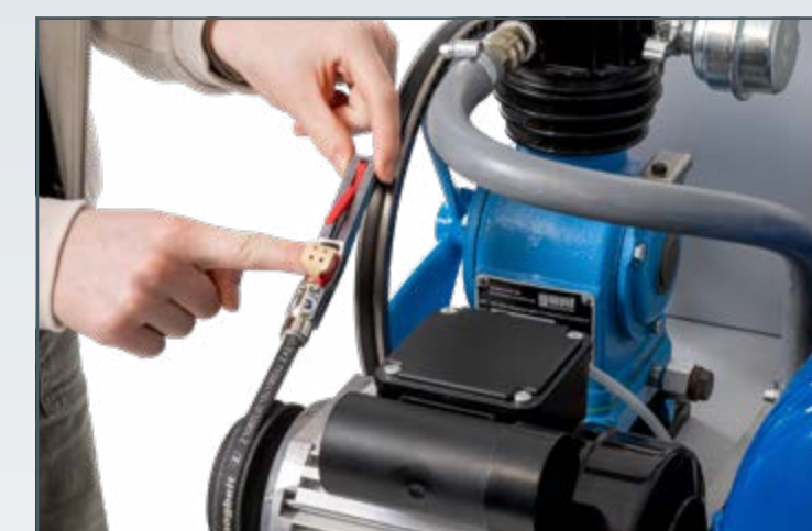
Comprobación de la tensión de la correa
