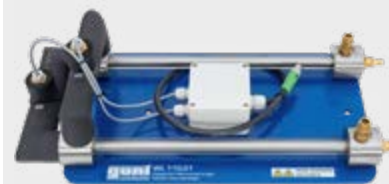
WL 110.01 Cambiador de calor de tubos concéntricos
