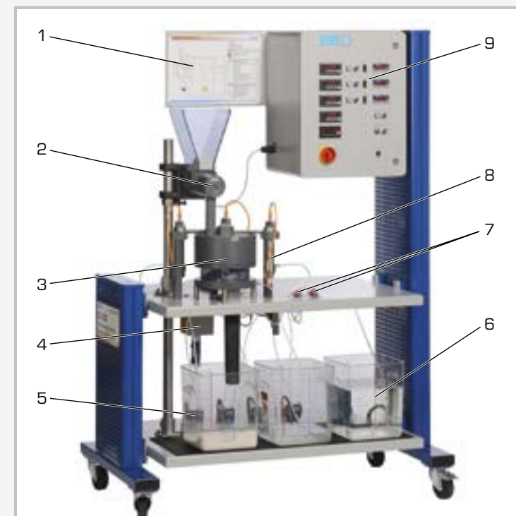
1 esquema del proceso, 2 tornillo sin fin para transporte del material de extracción, 3 extractor giratorio, 4 unidad de accionamiento del extractor giratorio, 5 bomba detrás de los recipientes, 6 recipiente, 7 válvulas para seleccionar el régimen de operación, 8 dispositivo de calefacción y alimentación de disolvente, 9 armario de distribución con elementos de mando
