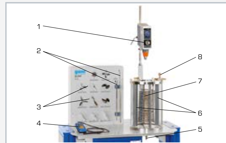
1 mecanismo de agitación con indicación del número de revoluciones y del par, 2 agitador de turbina y eje roscado para elementos de agitación, 3 elementos de agitación, 4 medidor de conductividad, 5 salida, 6 placa deflectora, 7 serpentín, 8 válvula de cierre para el serpentín
