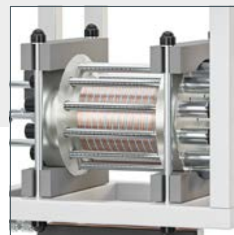
Pila de electrólisis con 18 celdas
