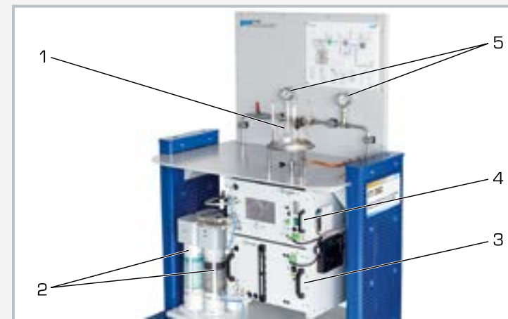
1 purificación del agua bruta, 2 depósito para el agua purificada, 3 electrolizador AEM con depósito para solución de hidróxido potásico, 4 quemador de gas, 5 manómetros para la presión del hidrógeno
