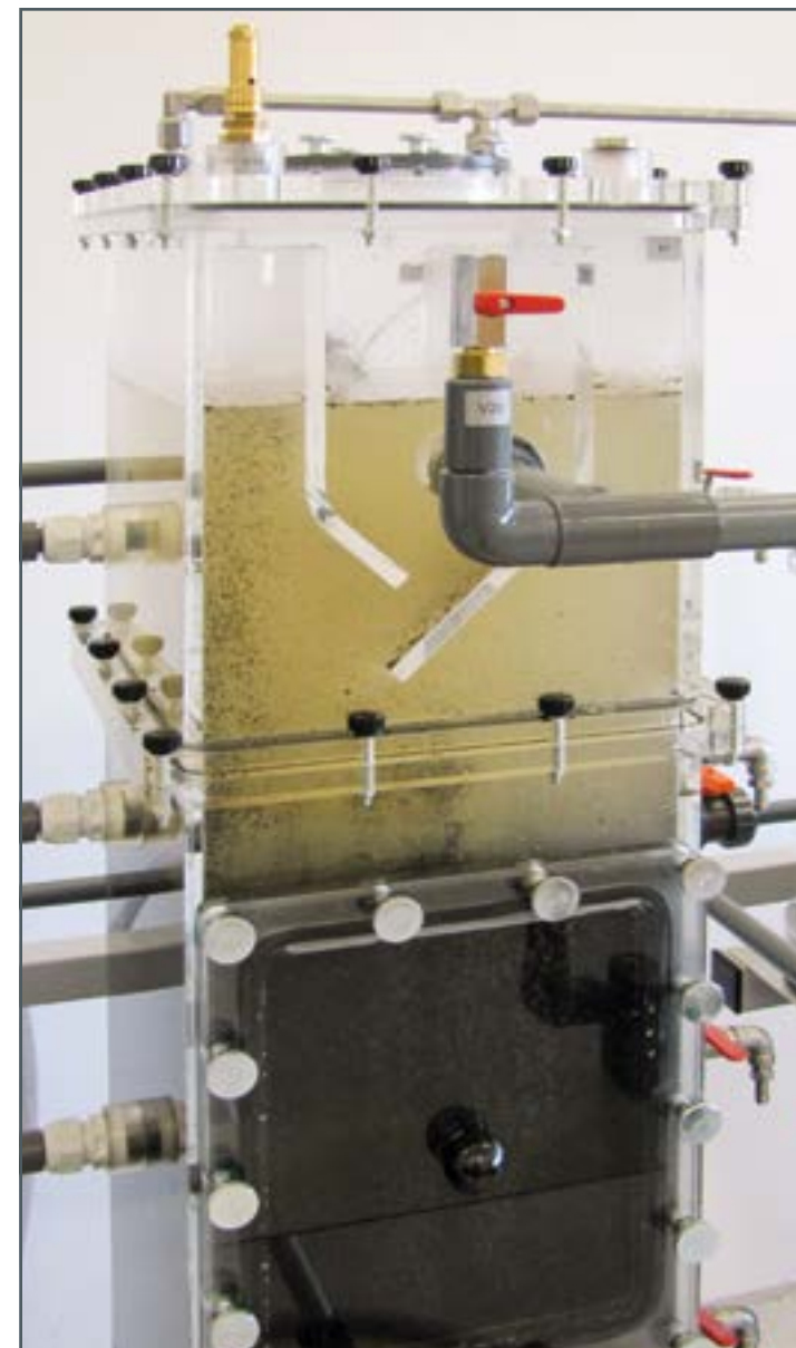
Reactor UASB del CE 702 durante el funcionamiento de prueba con éxito en nuestro laboratorio
