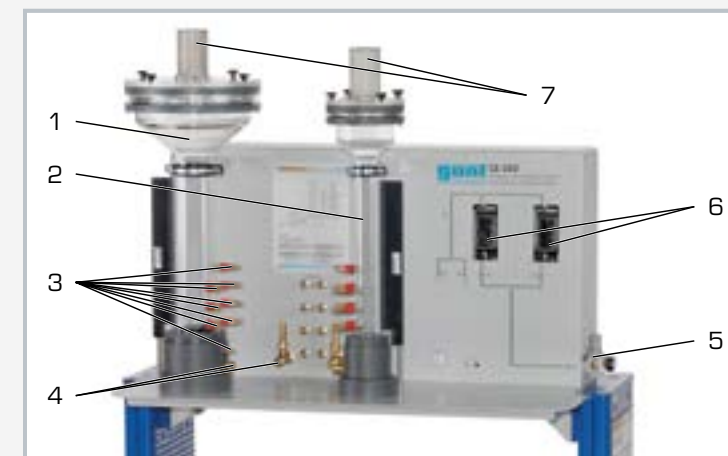
1 columna K1 con Ø 100mm, 2 columna K2 con Ø 50mm, 3 puntos de medición de la presión diferencial de K1, 4 alimentación de gas de K1, 5 alimentación de gas del banco de ensayos, 6 medición del caudal para 2 rangos de medición, 7 filtro de aire
