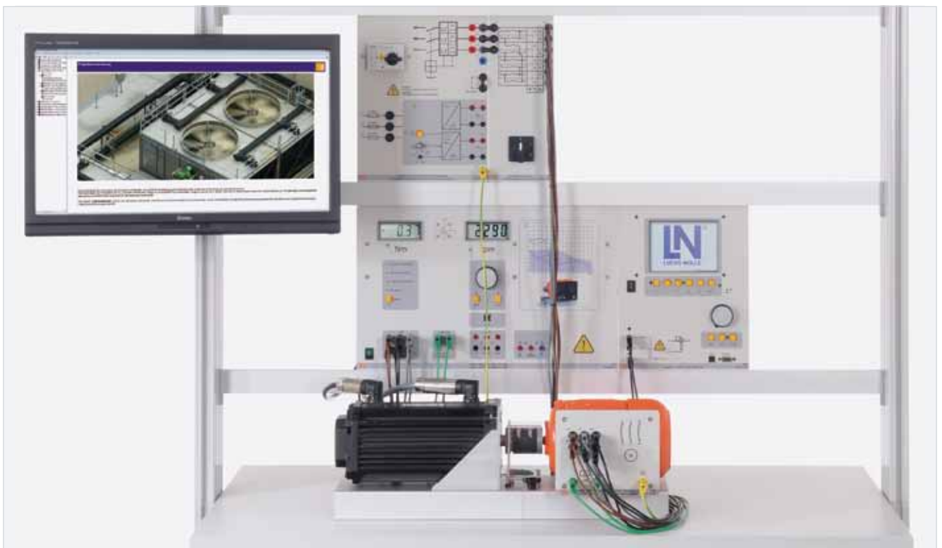
El sistema de capacitación "Accionamiento con distribución eficiente de carga" está compuesto por un motor asíncrono de corriente trifásica y un banco de prueba de servomotores.
